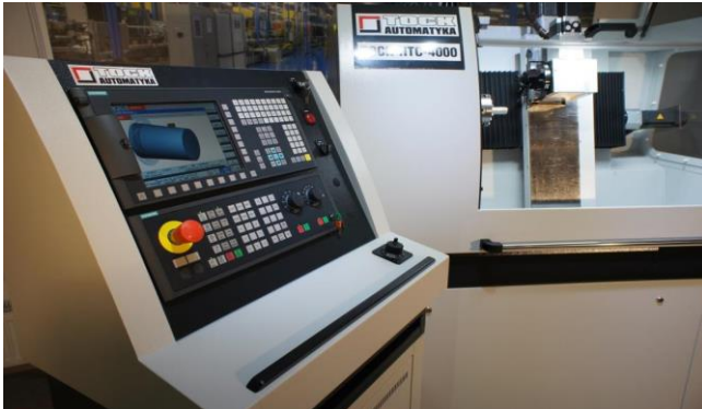
Widok sterownika Sinumerik 828D i automatycznej głowicy narzędziowej
