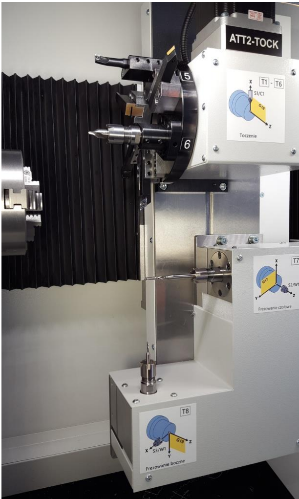
Widok automatycznej głowicy narzędziowej i głowicy z narzędziami napędzanymi. Widoczne schematy układów współrzędnych pracy.
